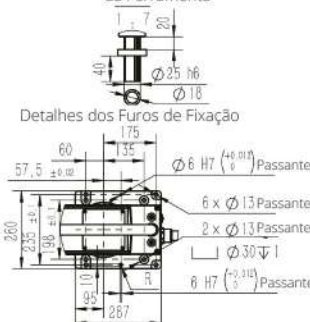
Detalhes dos Furos de Montagem da Base
