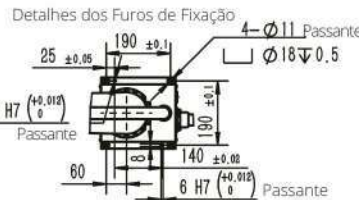
Detalhes dos Furos de Montagem da Base
